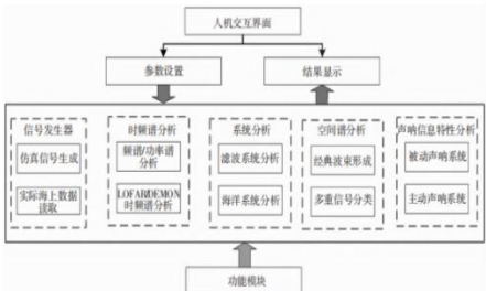
图 2 声呐信息与系统虚拟实验平台理论架构
